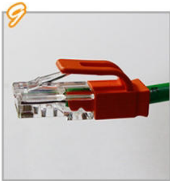
9.將護套推近水晶頭並將壓板放在彈片上，即完成
