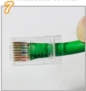
7.將卡線殼+線插入水晶頭並頂到最前端
