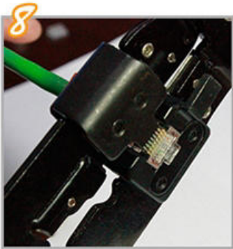
8.將水晶頭放入工具鉗相對應的卡口內，鉗壓金片
